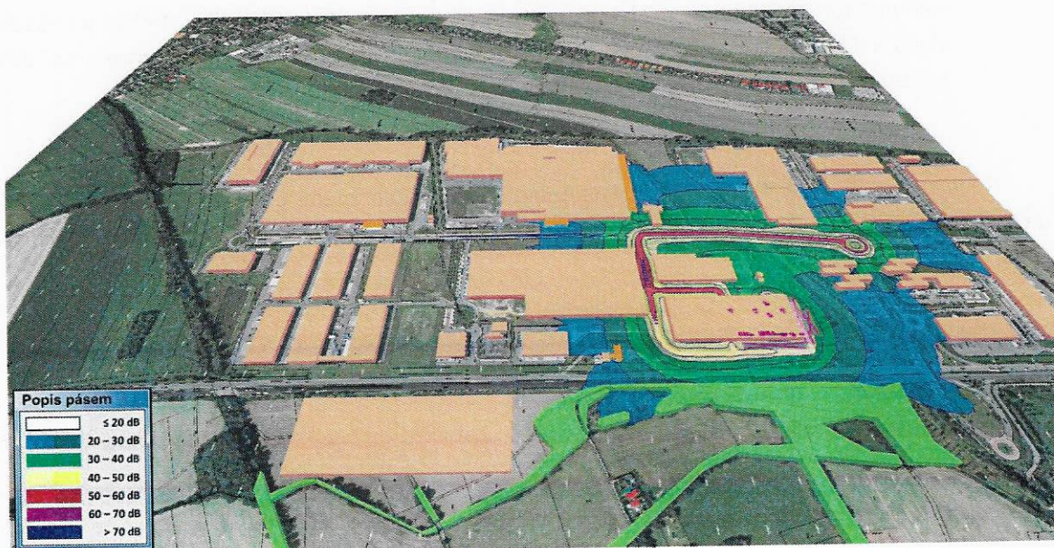
obr. 6 Zobrazení hlukových pásem Provoz v rámci areálu a ul. Na Rovince, DEN, 3D pohled
